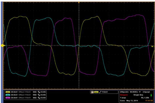
图 9. MIPI C-PHY 高速信号实例
