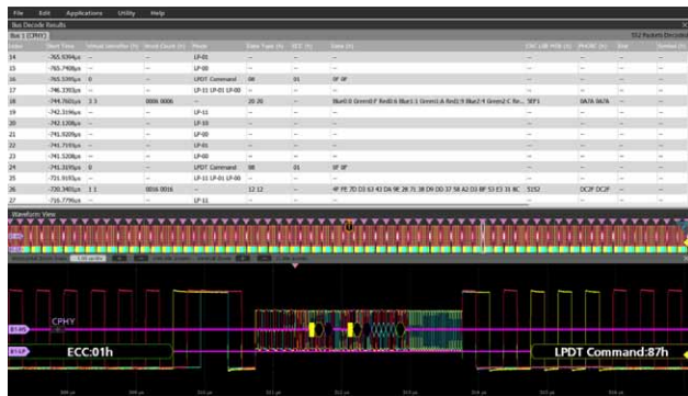
图 17. TekScope PC C-PHY 解码示意
