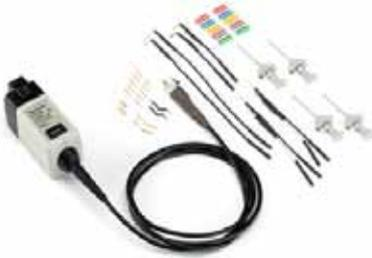
有源电压探头使泰克示波器能够真实地采集当前高速电路中的实时信号信息。有源探头提供了很宽的信号采集带宽，保证降低被测器件 (DUT) 负荷。在应用涉及高阻抗、高频电路单元，需要最小的负荷时，有源探头是更好的选择。在有 DC 偏置电压的情况下测量 AC 信号时，DC 偏置功能可以利用探头的全部动态范围。
